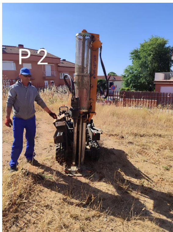
Figura Nº 9.- Trabajos para la realización de la penetración dinámica, tipo DPSH, referida como P-02.
