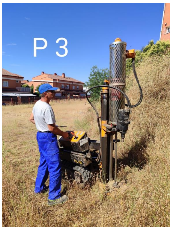
Figura Nº 10.- Trabajos para la realización de la penetración dinámica, tipo DPSH, referida como P-03.
