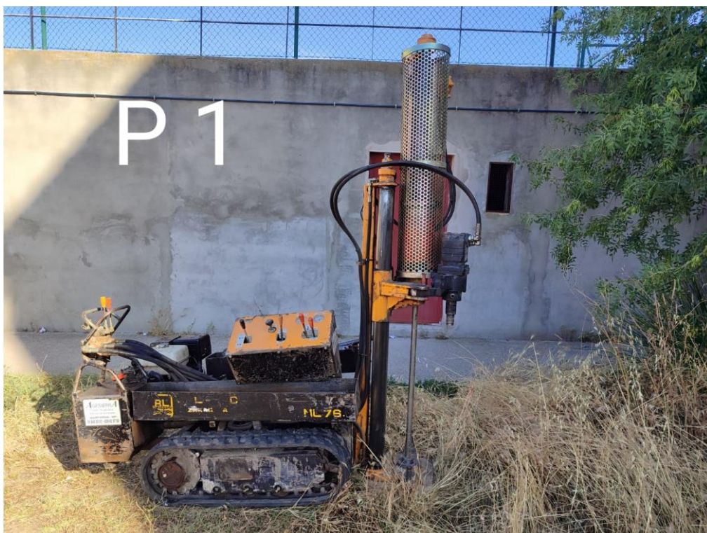
Figura Nº 8.- Trabajos para la realización de la penetración dinámica, tipo DPSH, referida como P-01.
